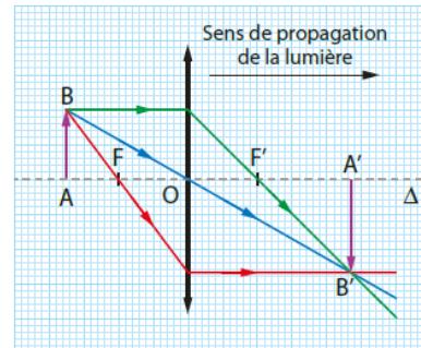
Par construction graphique, on constate que l'image  $A'B'$  donnée par la lentille mince convergente est renversée par rapport à l'objet, réelle et plus grande que l'objet.
